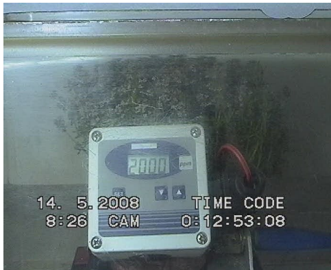
2000ppm! Höher kann das CO2 Messgerät nicht messen, nach ca. 102.min.
